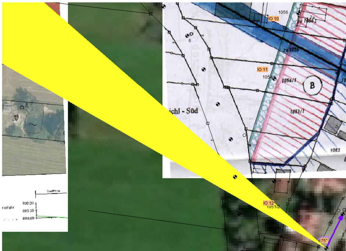
Abbildung 4.3: Blickwinkelanalyse der REG 5 (gelb: Reflexionsstrahlen, violett: Fahrtrichtung)
