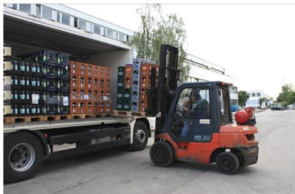
Für die Verladung der kommissionierten Paletten werden zwei Gasgabelstapler eingesetzt, welche die Paletten seitlich von der Ladefläche des Lkws entnehmen.
